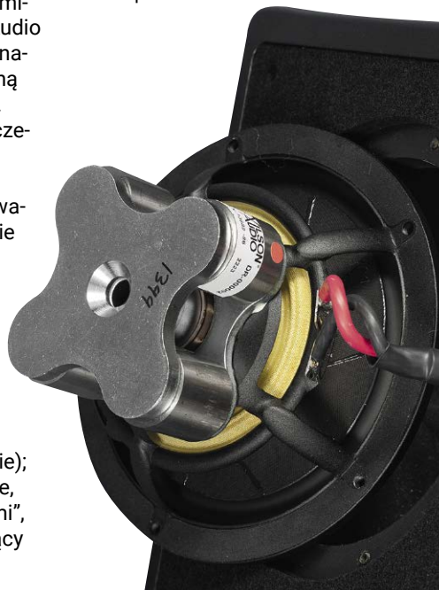
Jednak jego układ magnetyczny QuadraMag jest osobliwy i zastrzeżony tylko dla modelu zamówionego przez Wilson Audio.
